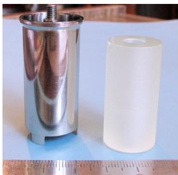
Рис. 1. Образец \text{BaWO}_4 (справа) и калориметрическая ампула (слева).
